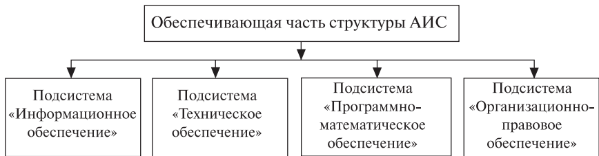
Рис. 3.1. Структура обеспечивающей части АИС
